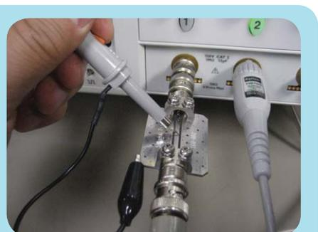
Figura 2-2. Carregamento da ponta provocado por condutor de aterramento comprido
