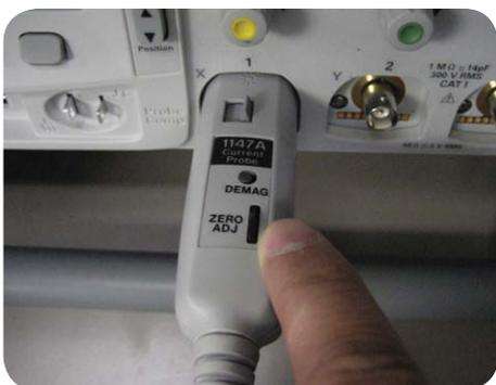
Figura 4-2. Para aumentar a precisão da ponta de corrente, elimine o magnetismo e o *offset* CC
