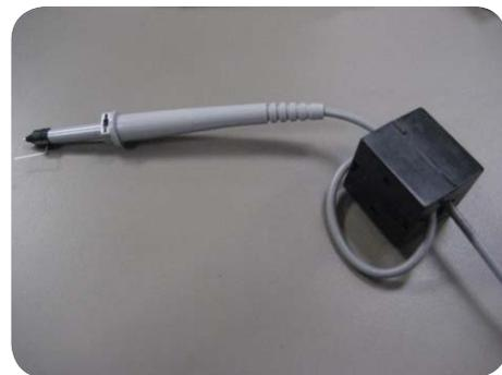
Figura 7-1. O uso de um núcleo de ferrite no cabo da ponta de prova pode ajudar a melhorar a precisão da coleta do sinal
