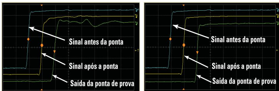
Figura 1.1. Comparação entre pontas de prova passiva e ativa na medição de um sinal que tem tempo de subida de 1 ns
