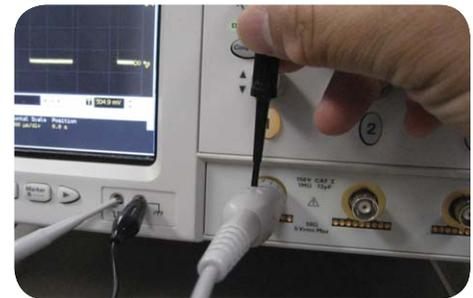
Figura 3-1. Use uma chave de fenda pequena para ajustar a capacitância variável da ponta de prova.
