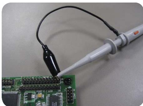
Figura 6-1. Conecte os dois terminais da ponta ao terra e veja se algum sinal é mostrado na tela.
