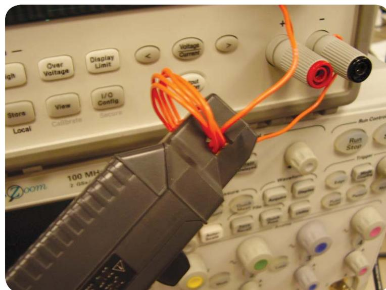
Figura 4-3. Aumente a sensibilidade da ponta enrolando algumas voltas do condutor sob teste ao redor da ponta
