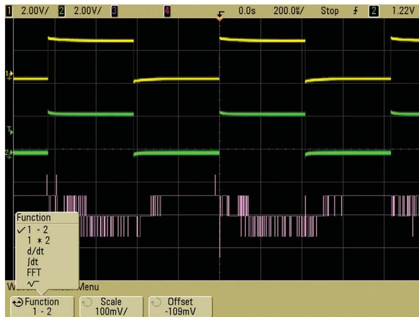
Figura 5-2. Como verificação de sanidade, use duas pontas de prova no mesmo sinal e veja o que é mostrado em "A-B".
